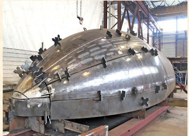
Formwerkzeug für die Nutzlastverkleidung der Vega-C-Rakete. Foto: Ostseestahl GmbH & Co. KG
