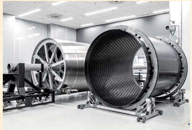
Mandrel mit Composite-Wickelstruktur für zylindrische Raumfahrtbauteile. Foto: ATG europe
